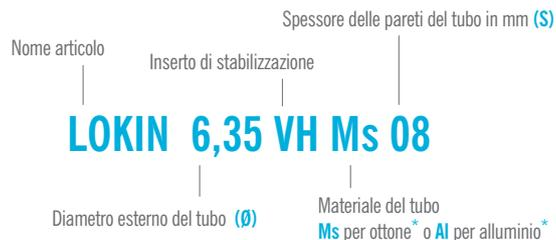
\*Utilizzare inserti di stabilizzazione in Ms per tubi in rame e in Al per tubi in alluminio.
