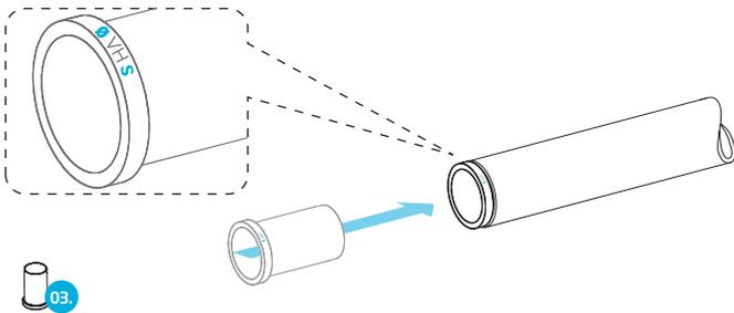
**2** 在涂覆 LOKPREP(04)前, 先将连接器套在管道上, 然后推动连接器直至触碰内部止块为止。在管道上标记(08)正确的插入深度。
