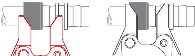
! **错误：** 未将管道推到内部止块。 **正确：** 拖动管道，直至感觉已触碰到内部止块。
