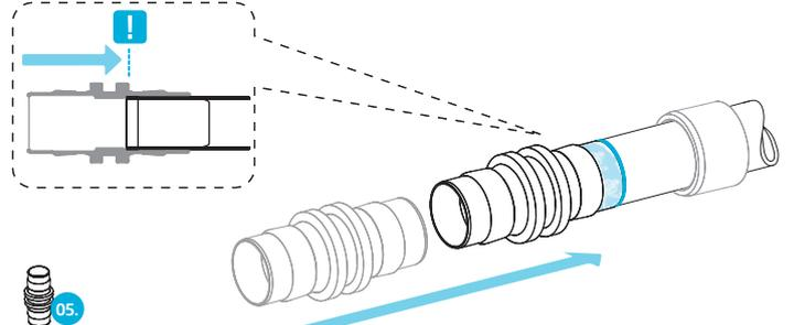
**5** 将组装钳口(06)放在 LOKRING(07)和连接器(05)组装止块后方的适当位置。通过按压将管道接口固定在一起。**!** 请勿改变管道和连接器的插入深度。按压管道接头, 直到将 LOKRING(07)推到连接器(05)的组装止块上。
