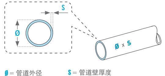
**1** 插入适用于材料、管道外径  $\varnothing$  和管道壁厚度  $S$  的固定插块(03)。如果使用工作压力低于 25 巴的冷却剂(例如, R134a 汽车空调系统或冰柜), 则不必使用固定插块。
