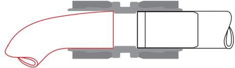
! **错误：** 未将组装钳口放在正确位置。 **正确：** 将组装钳口正确放平。
