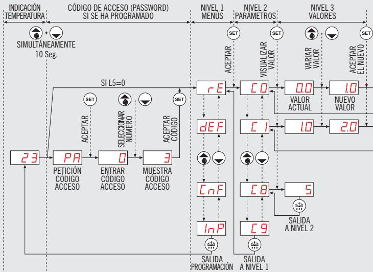
**NOTA:** Si no se pulsa tecla alguna durante 25 segundos en cualquiera de los pasos anteriores, el controlador volverá automáticamente a la situación de INDICACIÓN TEMPERATURA, sin modificar el valor de los parámetros.
