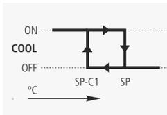
Lorsque la température dans la sonde 1 atteint la valeur du point de réglage (SP) moins le différentiel de la sonde (C1), le relais COOL est activé, ce qui alimente les résistances chauffantes et augmente la température. Lorsque la valeur du point de réglage (SP) est atteinte, le relais COOL est désactivé, ce qui engendre l'arrêt de l'alimentation des résistances.
