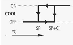
Lorsque la température dans la sonde 1 atteint la valeur du point de réglage (SP) plus le différentiel de la sonde (C1), le relais COOL est activé, ce qui fait démarrer le compresseur et chuter la température. Lorsque la valeur du point de réglage (SP) est atteinte, le relais COOL est désactivé, ce qui arrête le compresseur.
