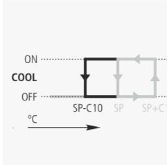
Lorsque ce mode est activé, le compresseur commence à fonctionner jusqu'à ce que la température dans la sonde 1 atteigne la valeur du point de réglage moins la variation indiquée dans le paramètre C10.
